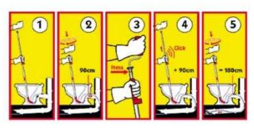
L'arbre de nettoyage est spécialement conçu pour une élimination rapide d'obstructions qui ce sont développés à l'intérieur et à derrière des toilettes. Le corps extrêmement robuste, dispose d'une spirale double épaisseur et d'un mécanisme de télescope permettant une utilisation compris entre 90 cm et 180 cm en extension, afin de couvrir les bouchons dans le tuyau d'écoulement les plus éloigné.
